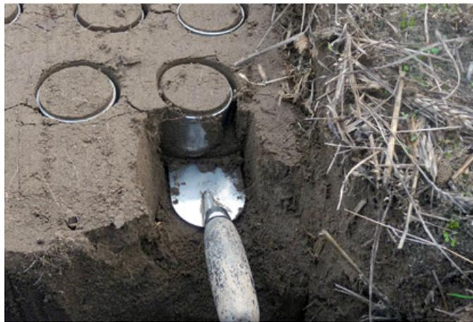
Abbildung 1: Probenahme mit Stechzylindern (Foto: J. Zimmer)
