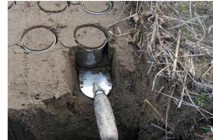
Abb. 1: Probenahme mit Steckzylindern (Foto: J. Zimmer)
